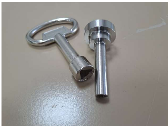
CHIAVE CON IMPRONTA TRIANGOLARE PER LA PORTA A DESTRA E LA CHIAVE CON IMPRONTA CIRCOLARE PER LA PORTA A SINISTRA.
